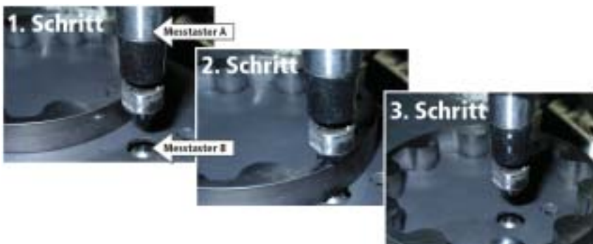
Messung der Werkstückdicke nach dem Diskus-Schleifen
